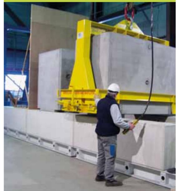
Basée à Saint-Dizier, l'entreprise MCM Orflam (du groupe Meusienne de construction mécanique), participe à la mise au point d'un système de manutention pour les déchets de moyenne activité à vie longue. Un banc d'essai y a été monté afin de tester l'empilage et le transport de conteneurs en béton pouvant peser jusqu'à 16 tonnes. Il servira notamment à simuler des incidents de collision.
