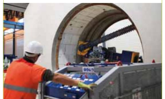
Un tunnel factice édifié dans l'Espace technologique du Centre de Meuse/Haute-Marne abrite un essai grandeur nature sur le scellement des ouvrages de stockage : une saignée en forme d'anneau y a été tranchée sur 2,5 m de profondeur et 30 cm de large afin d'être remplie d'une argile gonflante appelée bentonite qui jouera un rôle de barrière étanche.
