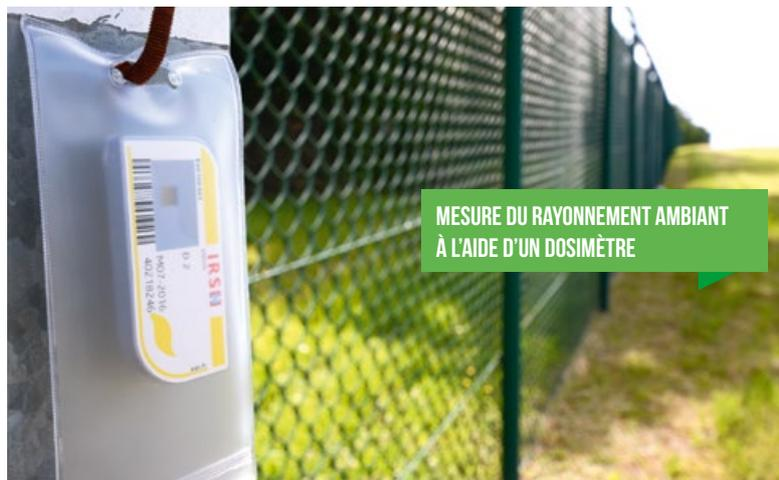
MESURE DU RAYONNEMENT AMBIANT À L'AIDE D'UN DOSIMÈTRE
