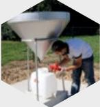
**2** Pluviomètre : analyse radiologique et mesure de la hauteur des eaux de pluie
