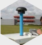
**1** Station atmosphérique : mesure de la radioactivité dans l'air (gaz et poussières)
