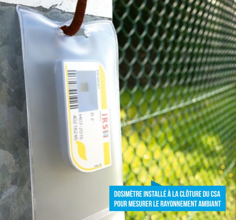
DOSIMÈTRE INSTALLÉ À LA CLÔTURE DU CSA POUR MESURER LE RAYONNEMENT AMBIANT
