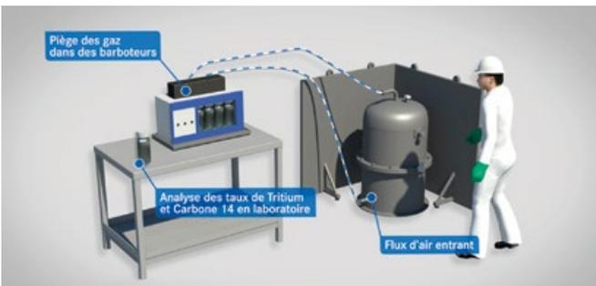
Les mesures de dégazage seront effectuées dans un local dédié. Le colis à contrôler sera chargé dans une enceinte fermée, constituée d'une cloche raccordée à un système de piégeage d'éventuels gaz. Un flux d'air sera envoyé dans la cloche, et le flux sortant dans des barboteurs (flacons) afin de piéger les éventuels gaz tritium et carbone 14. Les flacons seront analysés en laboratoire.
