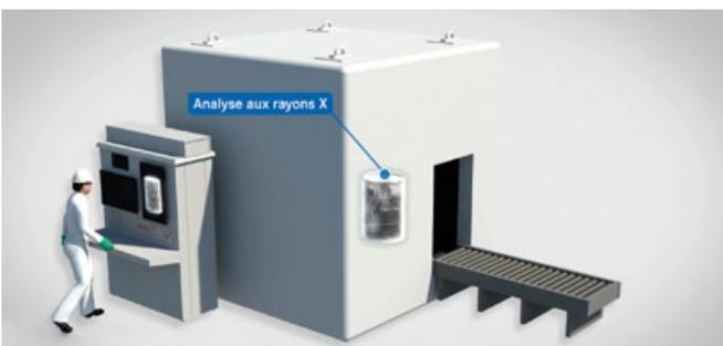
Le contenu du colis pourra être contrôlé par scanner aux rayons X de façon à vérifier sa qualité et l'absence de déchets interdits.
