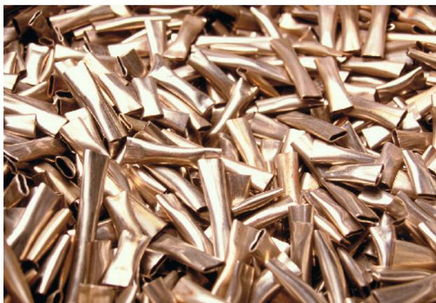
Coques issues des gaines en alliage de zirconium qui enrobent les pastilles de combustible
