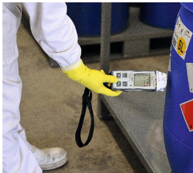
Contrôle radiologique : mesure des rayonnements d'un colis de déchets
