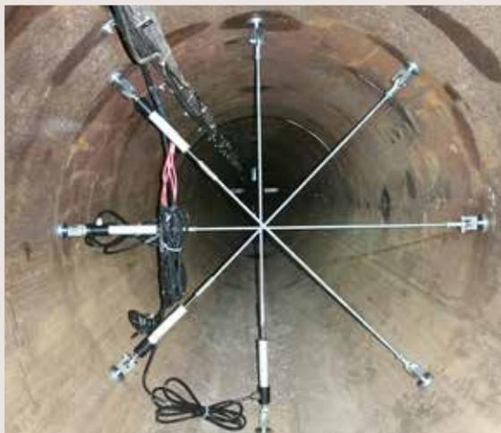
Section de mesure de convergence du chemisage installée à une distance d'environ 30 m de la galerie d'accès dans le démonstrateur d'alvéole AHA1604
