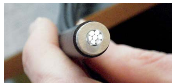
Des fibres optiques relient le détecteur à l'électronique qui traite le signal. Cette déportation de l'électronique permet d'avoir des sondes de plus petite taille et de ne pas perturber la zone d'étude.
