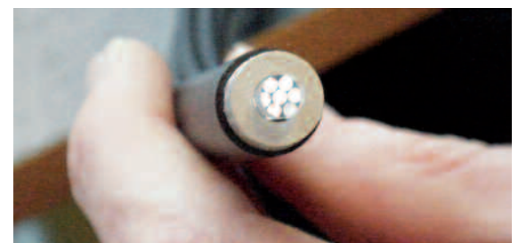
Des fibres optiques relient le détecteur à l'électronique qui traite le signal. Cette déportation de l'électronique permet d'avoir des sondes de plus petite taille et de ne pas perturber la zone d'étude.
