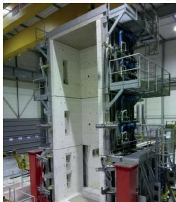
► Four Vulcain du CSTB (four vertical d'une puissance de 13,5 MW permettant de tester des éléments de 3 m de largeur et jusqu'à 9 m de hauteur avec éventuellement l'application d'un chargement mécanique)
