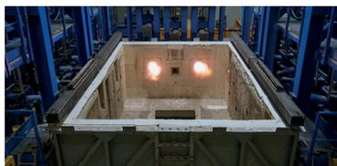
► Four Promethee du CERIB (four horizontal d'une puissance de 16 MW permettant de tester des éléments d'une dimension allant jusqu'à 6 x 4 m avec 20 vérins verticaux et 9 vérins horizontaux)
