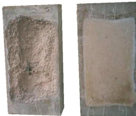
► Blocs de bétons soumis à un essai feu : à gauche, formulation sans fibres et à droite formulation avec fibres PP (Shuttleworth, 2001)<sup>1</sup>
