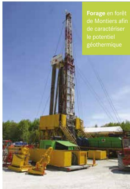
Forage en forêt de Montiers afin de caractériser le potentiel géothermique
