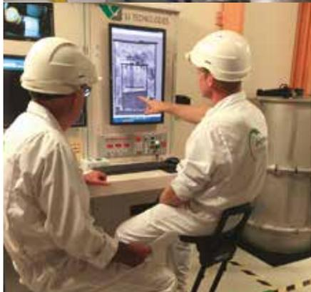
Contrôle au scanner à rayons X d'un colis de déchets radioactifs
