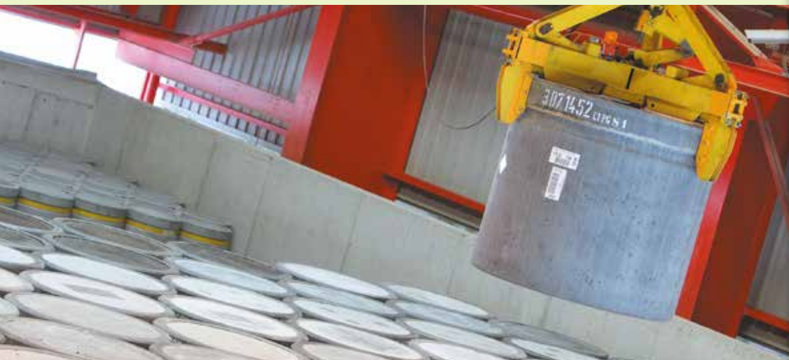
Ouvrage de stockage au CSA
