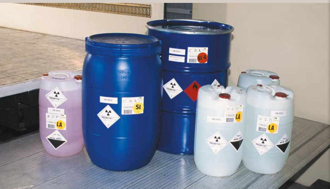
Colis de déchets radioactifs collectés
