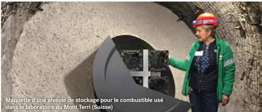
Maquette d'une alvéole de stockage pour le combustible usé dans le laboratoire du Mont Terri (Suisse)
