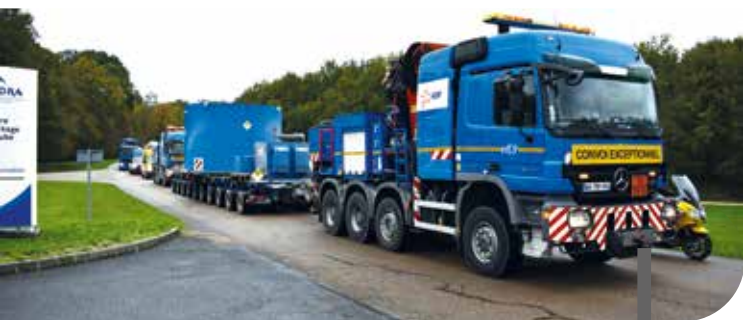
RÉCEPTION DU COUVERCLE DE CUVE DU RÉACTEUR de la centrale de Chooz A en démantèlement
