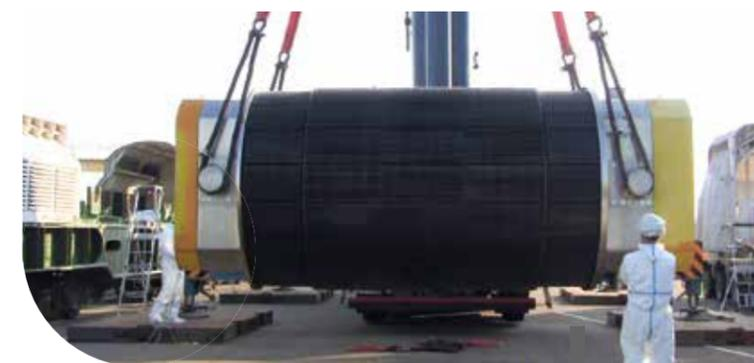
DÉCHARGEMENT D'UN EMBALLAGE DE TRANSPORT OBSOLETE au terminal ferroviaire de l'Andra
