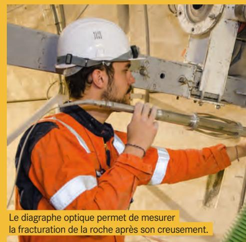
Le dilatomètre optique permet de mesurer la fracturation de la roche après son creusement.
