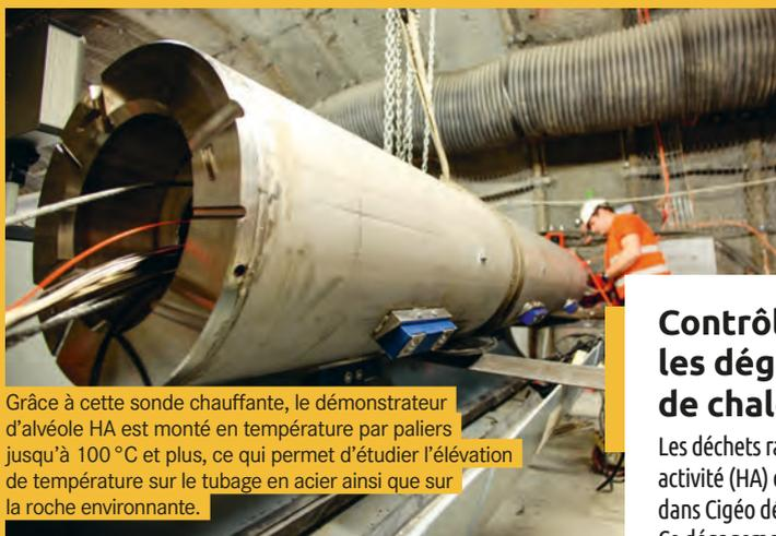
Grâce à cette sonde chauffante, le démonstrateur d'alvéole HA est monté en température par paliers jusqu'à 100 °C et plus, ce qui permet d'étudier l'élévation de température sur le tubage en acier ainsi que sur la roche environnante.
