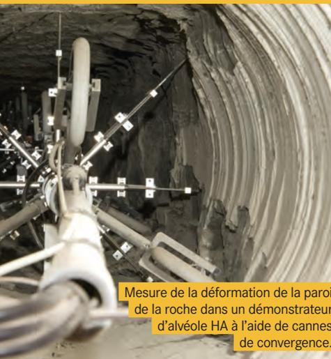
Mesure de la déformation de la paroi de la roche dans un démonstrateur d'alvéole HA à l'aide de cannes de convergence.
