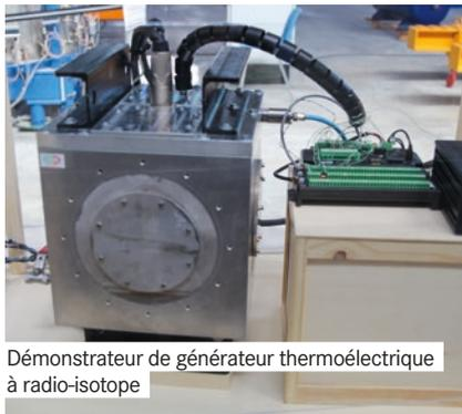
Démonstrateur de générateur thermoélectrique à radio-isotope
