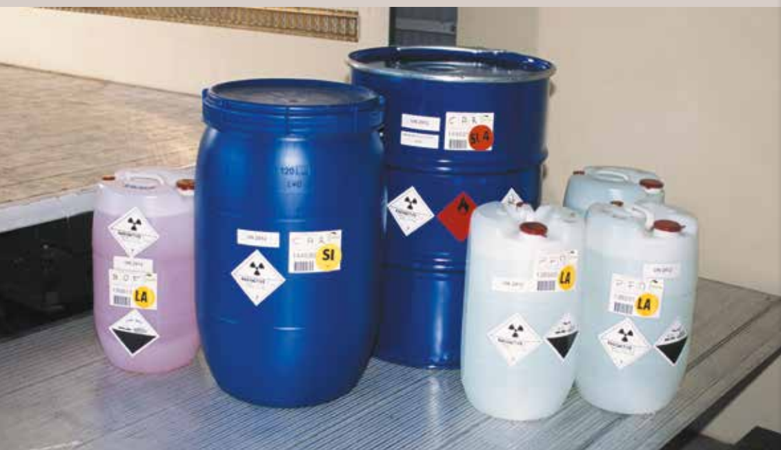
Colis de déchets radioactifs collectés
