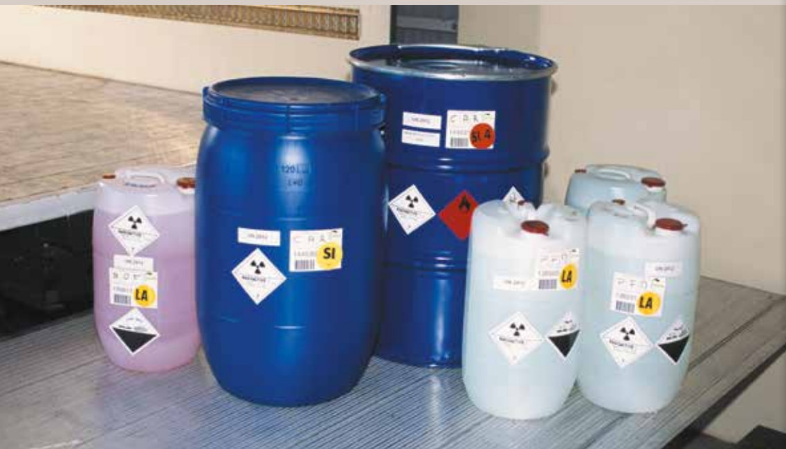
Colis de déchets radioactifs collectés
