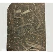
Essais de conditionnement d'éléments métalliques au sein de mortiers incorporant le piégeur de tritium
