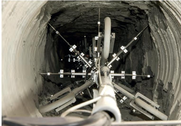
Mesure de la déformation de la paroi de la roche dans un démonstrateur d'alvéole de stockage de déchets radioactifs de haute activité à l'aide de cannes de convergence.
