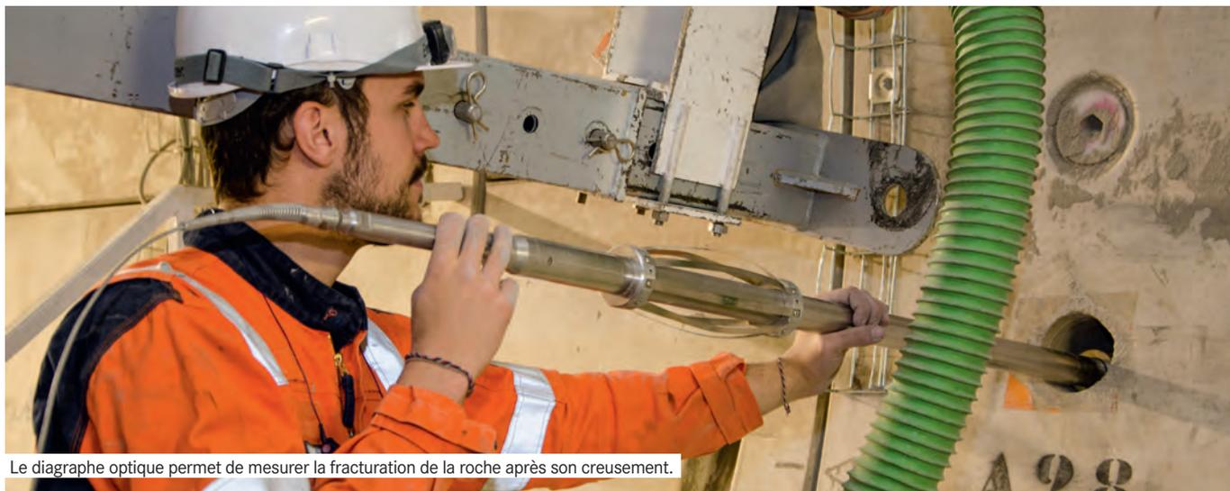
Le diagraphe optique permet de mesurer la fracturation de la roche après son creusement.
