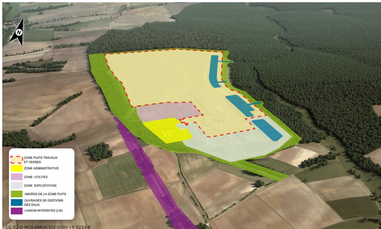
Figure 3-4 Localisation des installations de la zone puits travaux et verses
