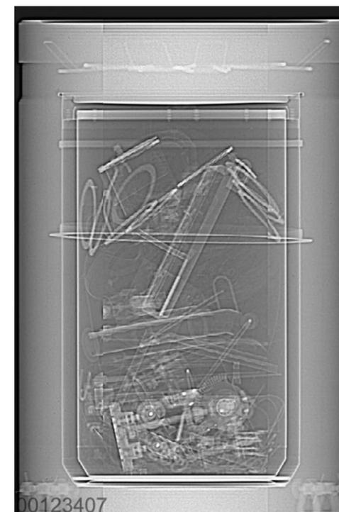
Figure 17-1 Photographie d'une radiographie très haute énergie d'un colis contenant un fût de déchets technologiques placé dans un conteneur en béton
