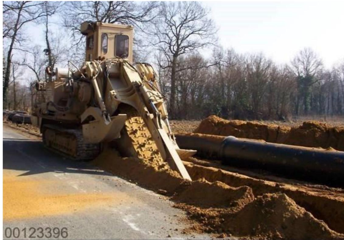
Figure 5-16 Trancheuse pour pose de canalisation
