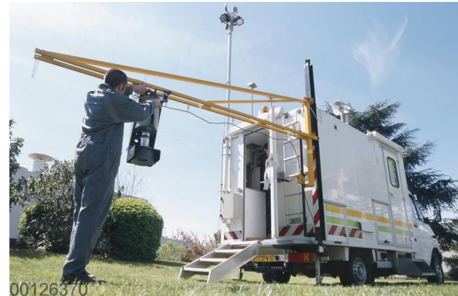
Figure 18-6 Illustration de dispositif de cartographie radiologique
