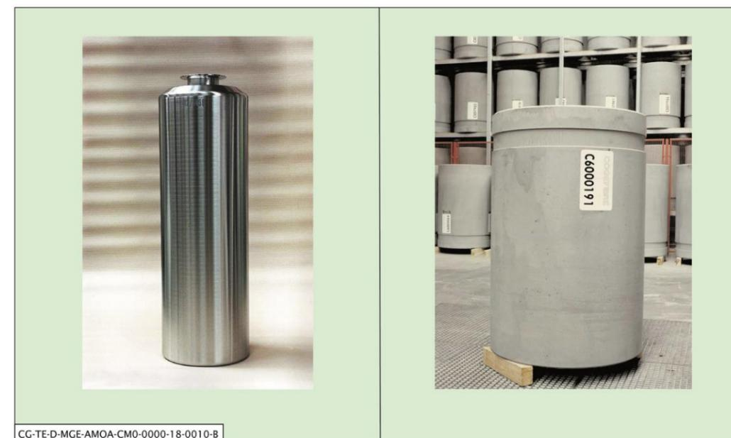
Figure 17-4 Photos de colis de déchets radioactifs (déchets solidifiés et immobilisés sous une forme non dispersable et placés dans des fûts en acier ou en béton)
