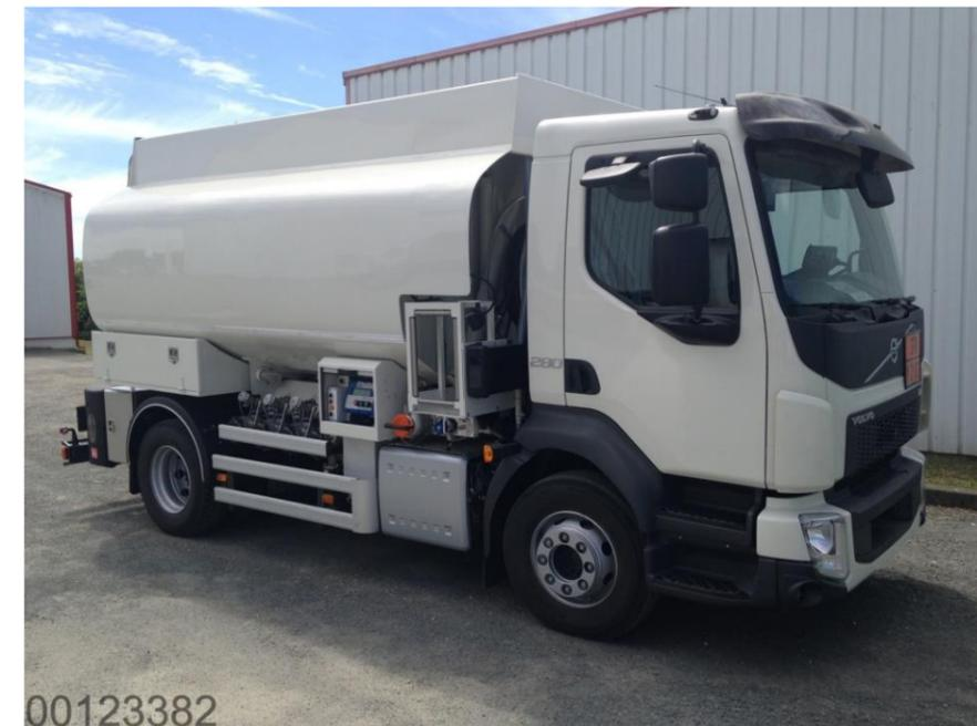
Figure 17-18 Photo d'un camion-centre de livraison de carburant
