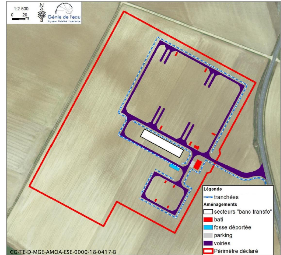
Figure 5-17 Exemple d'aménagements de surface d'un poste électrique (hors équipements électriques) avec les ouvrages hydrauliques
