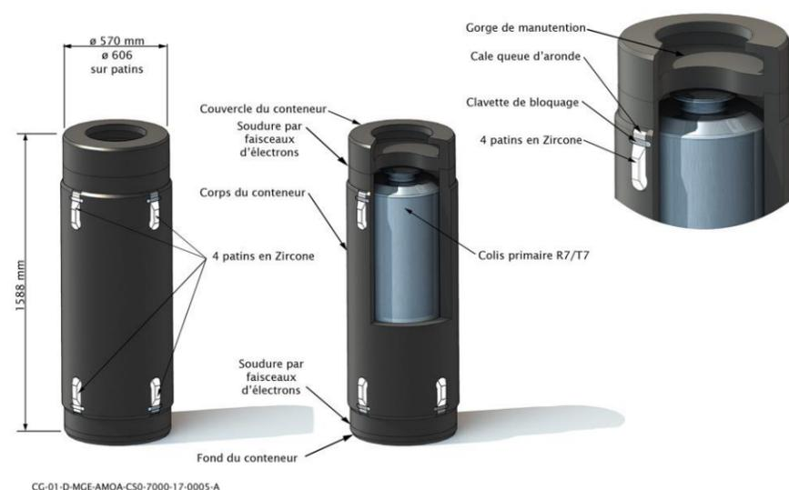
Figure 18-12 Illustration d'un colis de stockage de déchets vitrifiés avec son conteneur de stockage (Extrait du Dossier d'option de sûreté – partie après fermeture (20))
