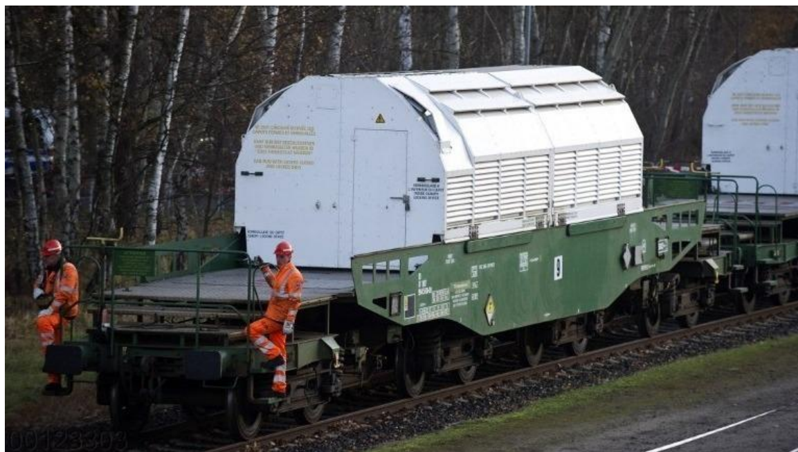
Figure 3-6 Photographie d'emballages de transport de déchets radioactifs sur un train
