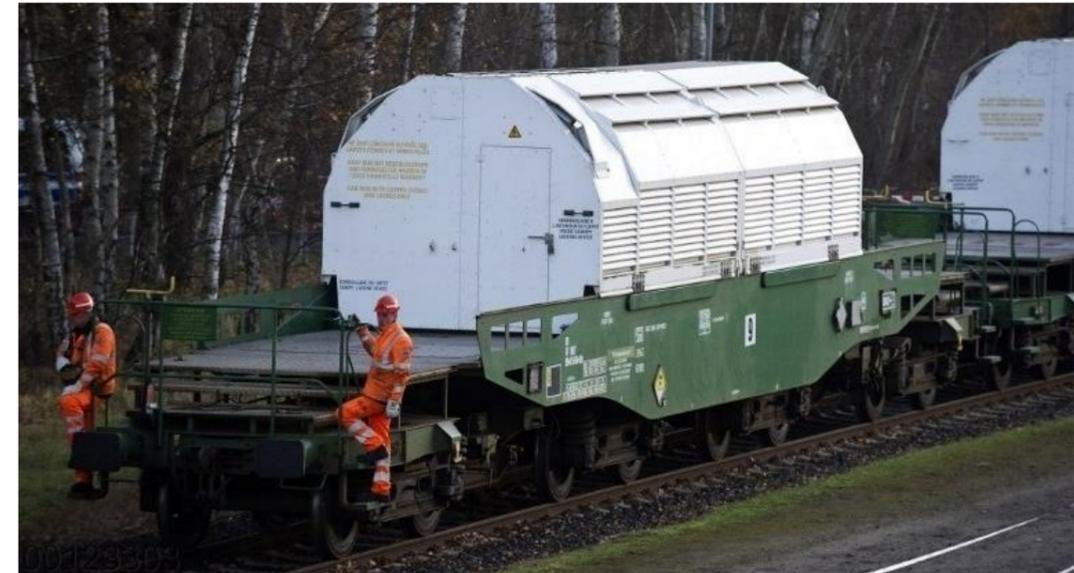
Figure 5-27 Emballages de transport de déchets radioactifs sur un train
