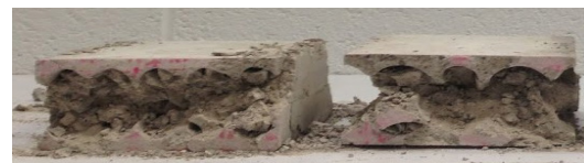
Essais mécaniques de compressibilité sur différents échantillons de variantes de blocs compressibles
