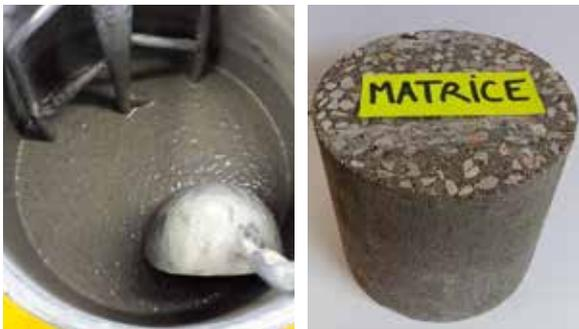
Procédé de conditionnement de déchets irradiants étudié dans le cadre du projet MATRICE : à gauche, photographie du test de vibrocompaction ; à droite : photographie du résultat obtenu à l'issue du test
