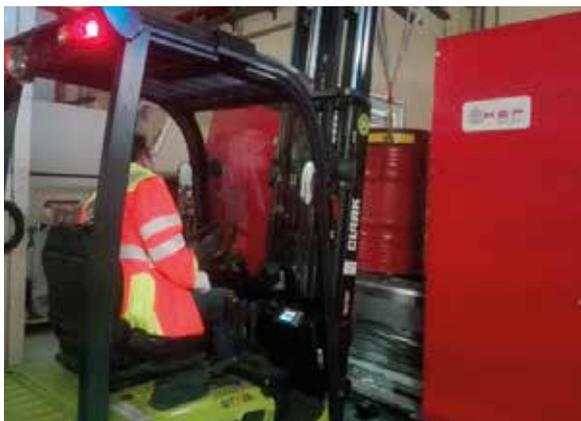
Photographie des équipements développés dans le cadre du projet européen CHANCE : mise en place d'un fût dans le calorimètre
