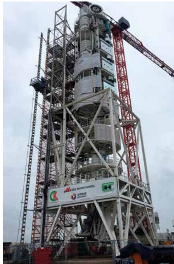
*Photographie d'un exemple de tunnelier vertical*
