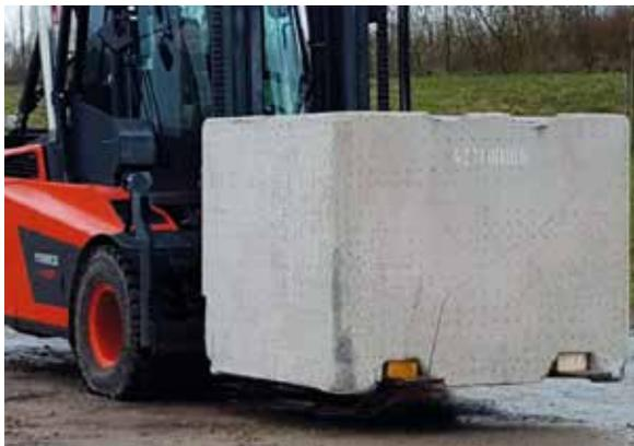
Photographie de l'essai de manutention d'un conteneur de stockage de déchets MA-VL après un essai au feu
