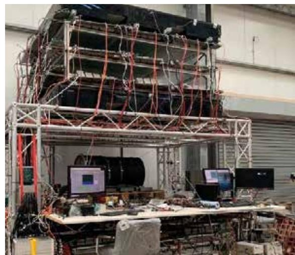
Photographie des équipements de tomographie muonique développés dans le cadre du projet européen CHANCE
