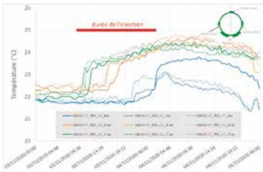
Démonstrateur d'alvéole de stockage de déchets HA AHA1607 : évolution des températures mesurées par les capteurs à fibre optique en Raman-DTS lors de l'injection du matériau de remplissage dans l'espace annulaire pour chacune des génératrices (en vert, au fond du démonstrateur ; en rouge, à mi-longueur ; en bleu, en tête)
