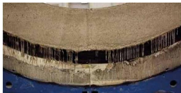
Photographies des panneaux compressibles après coulage du revêtement pour les trois différents matériaux testés (ciment/billes de verre, ciment/polystyrène expansé, mousse de verre)
