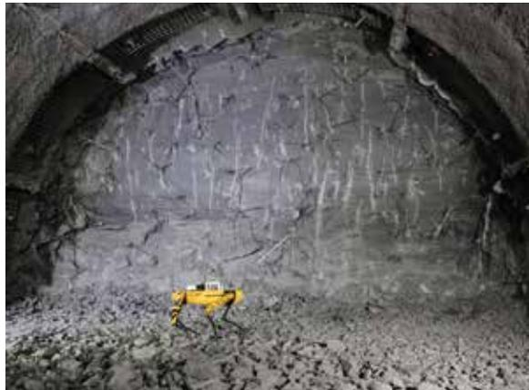
Photographie du robot SCAR se déplaçant sans chuter sur les déblais devant le front de taille de la galerie GRD6 du Laboratoire souterrain de Meuse/Haute-Marne
