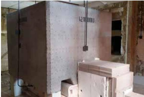
Photographie d'un conteneur de stockage de déchets MA-VL en configuration d'essai de tenue à un incendie externe (essai au feu)
