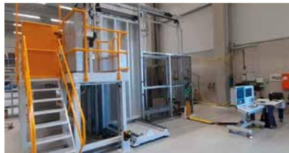
*Photographie de la machine de soudage par faisceau d'électrons de la tête d'un conteneur de stockage de déchets HA sur le corps du conteneur*
