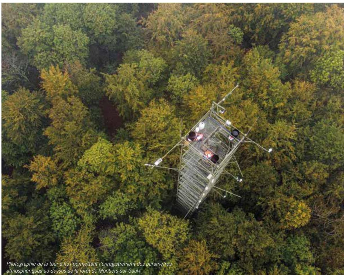
*Photographie de la tour à flux permettant l'enregistrement des paramètres atmosphériques au-dessus de la forêt de Montiers-sur-Saulx*
