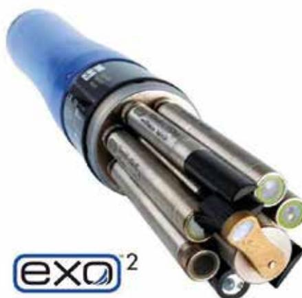
Photographie d'une sonde multi-paramétrique EXO2(YSI) déployée sur le territoire de l'OPE pour le suivi en continu de la qualité des eaux de cours d'eau
