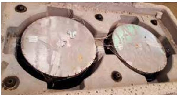
Photographies de l'état interne des conteneurs de stockage de déchets MA-VL après un essai au feu : conteneur de stockage avec fibres polypropylène (en haut) et sans fibre (en bas)
