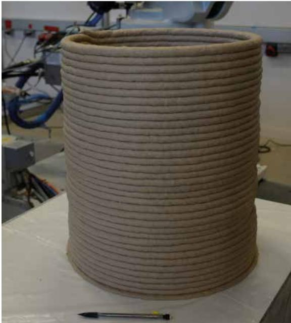
*Photographie d'un prototype à l'échelle 1/2 d'un chemisage d'alvéole de stockage de déchets HA en géopolymère réalisé en laboratoire par fabrication additive*
