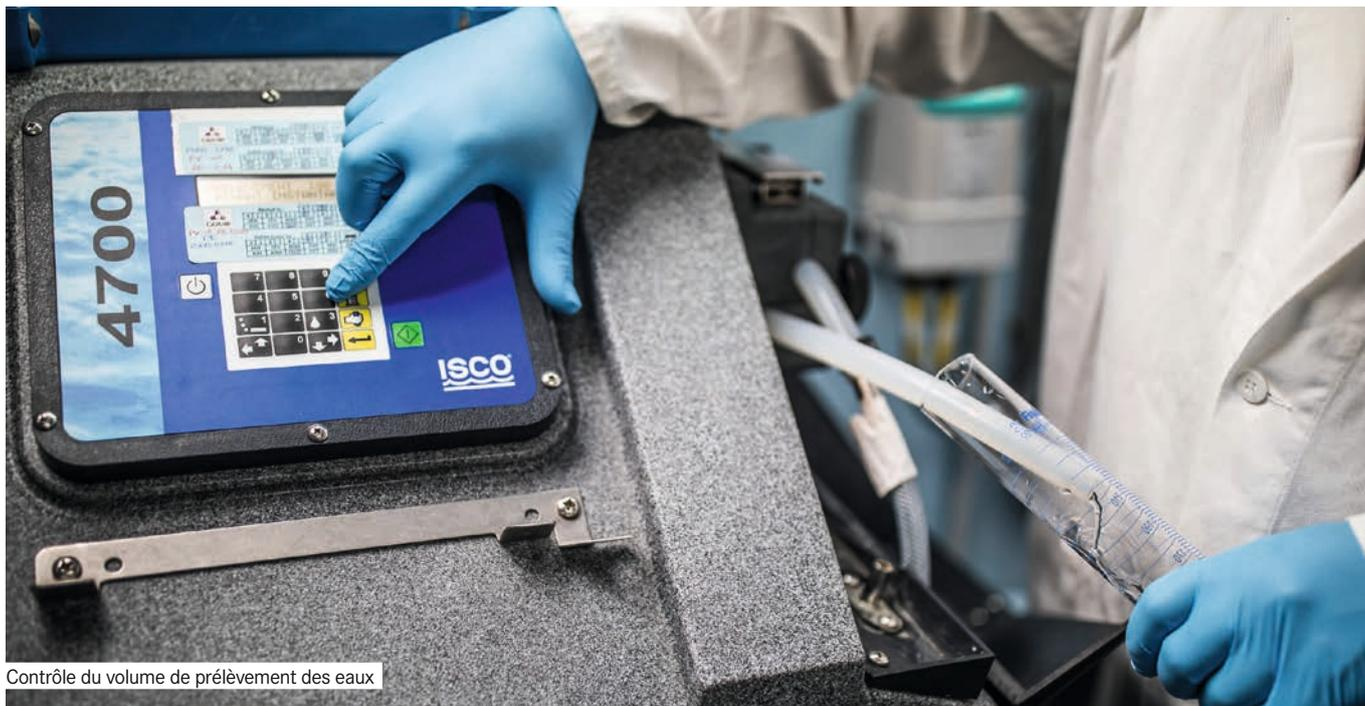
Contrôle du volume de prélèvement des eaux
