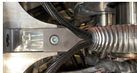
Dispositif de découpe de câble du projet Orcade
