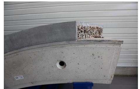
Les différents éléments du voussoir : la couche inférieure incompressible en béton ; la couche intermédiaire compressible ; la couche supérieure de protection.
