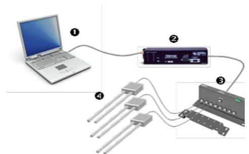
1. PC équipé de « ESI-TDR » (logiciel Andra d'acquisition et d'interprétation automatisées des mesures).
