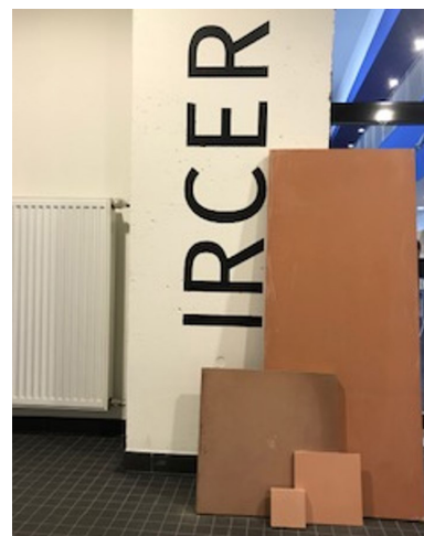
Echantillons en géopolymères à propriétés ignifuges
