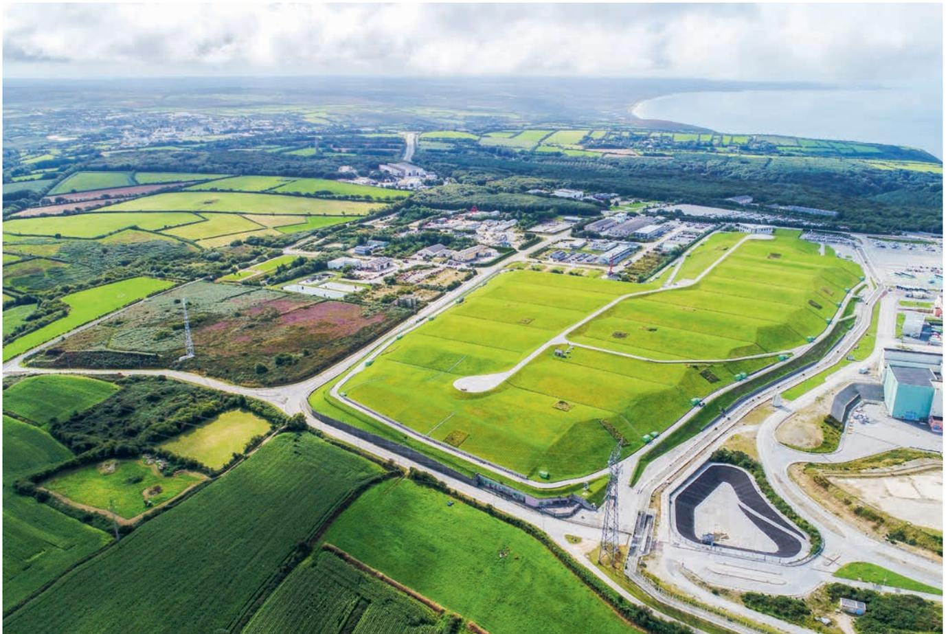
C'est ainsi qu'a été installée entre 1991 et 1997 une couverture dont le rôle est de constituer un « parapluie » étanche au-dessus de toute la zone de stockage. Car en limitant les infiltrations d'eau, elle limite les risques de dispersion de la radioactivité dans l'environnement, dans la nappe d'eau souterraine en particulier, et permet de respecter les objectifs de sûreté (soit 5 L/m<sup>2</sup>/an d'infiltration).
