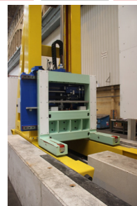
Engin de manutention avec fourches télescopiques.
