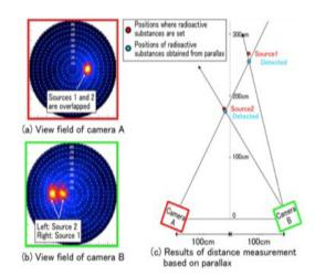
Principe d'estimation de la distance entre chaque source de rayonnement et le détecteur.
