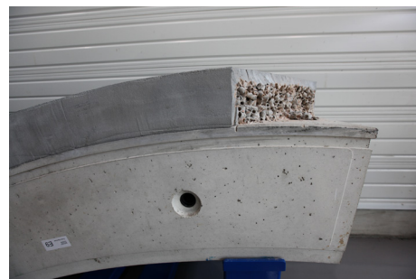
Les différents éléments du voussoir : la couche interne incompressible en béton ; la couche intermédiaire compressible ; la couche externe de protection.
