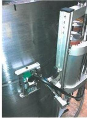
Mesure et vérification du niveau des contraintes résiduelles dans la zone détensionnée.
