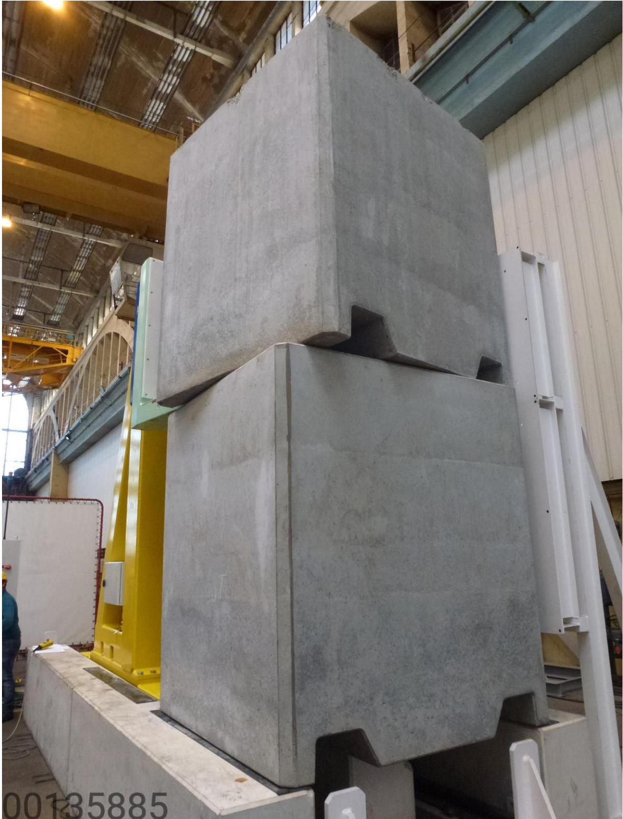
Figure 6-7 Photographie du banc d'essais de retrait de colis de stockage MA-VL
