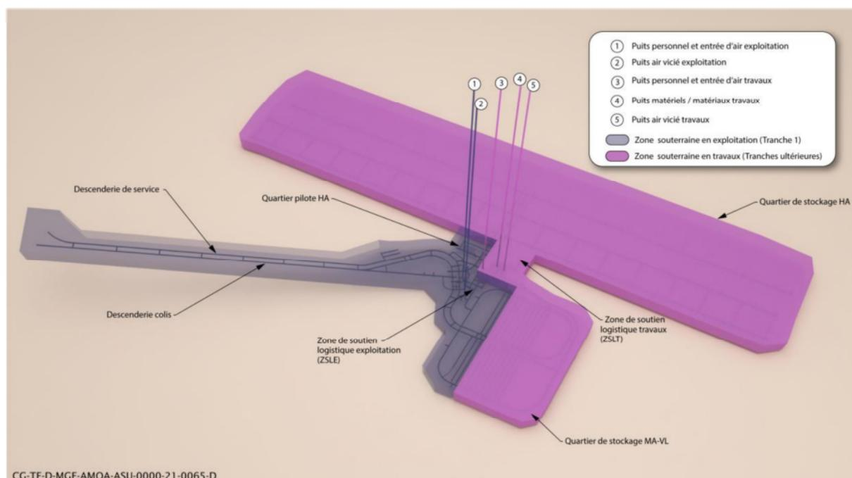
Figure 2-5 *Illustration de principe de séparation des zones souterraines en exploitation et en travaux et liaisons surface-fond associées (dimensions et proportions non représentatives)*
