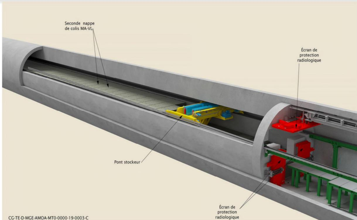
Figure 2-3 Illustration d'un alvéole MA-VL
