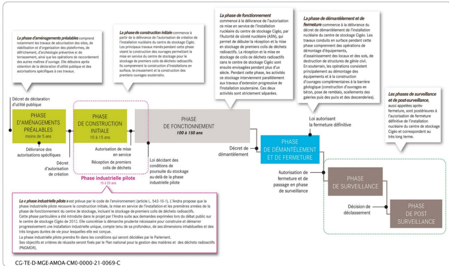
Figure 1-3 Les différentes phases temporelles de déploiement du centre de stockage Cigéo
