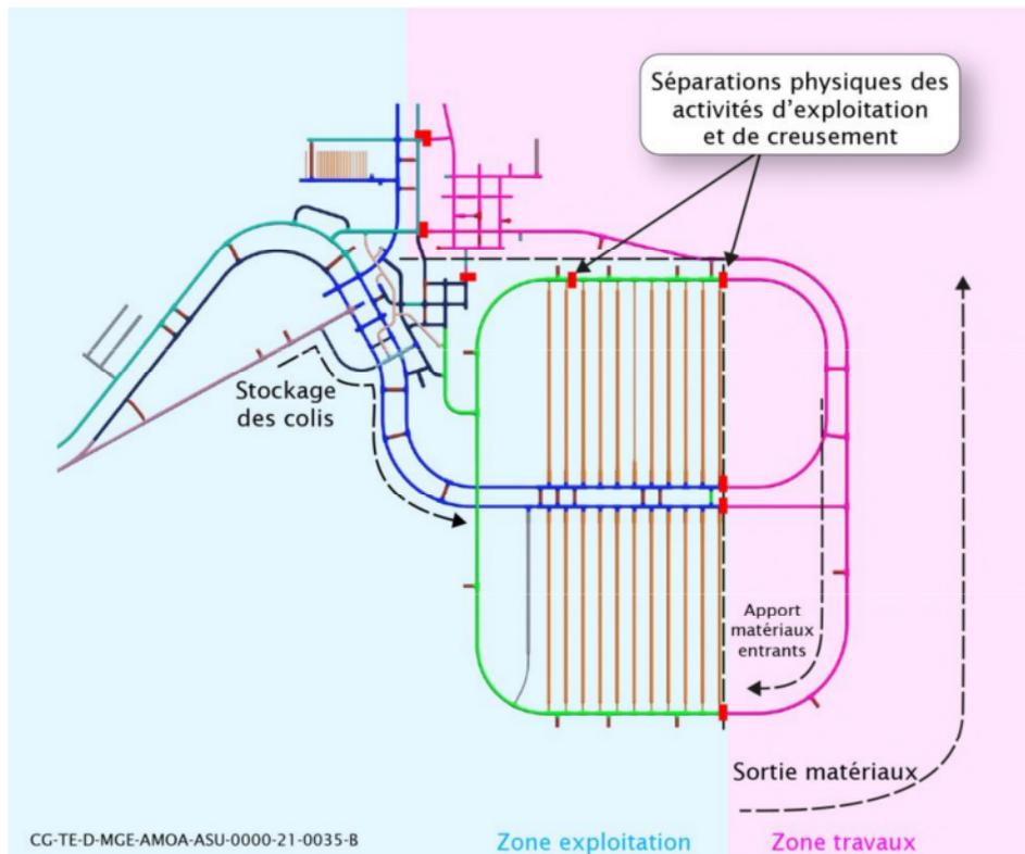
Figure 6-2 Illustration des interfaces entre la zone en exploitation et la zone en travaux – Quartier de stockage MA-VL
