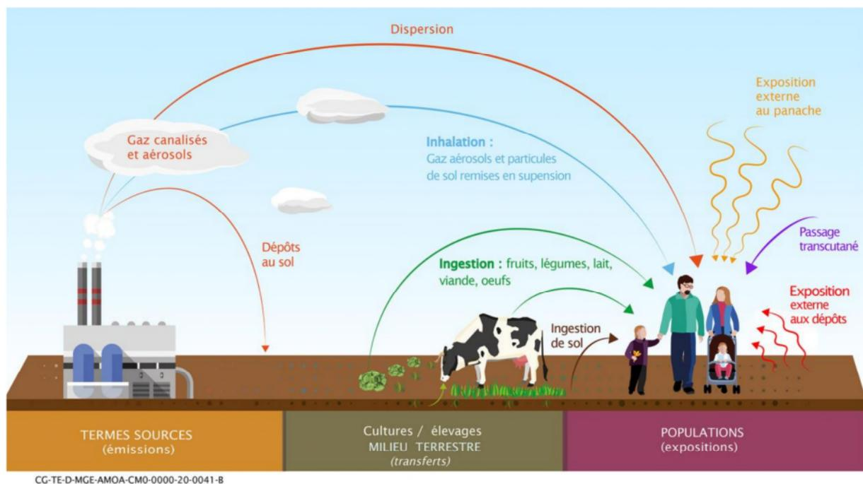
Figure 5-2 Représentation schématique des voies de transfert et d'exposition des émissions atmosphériques
