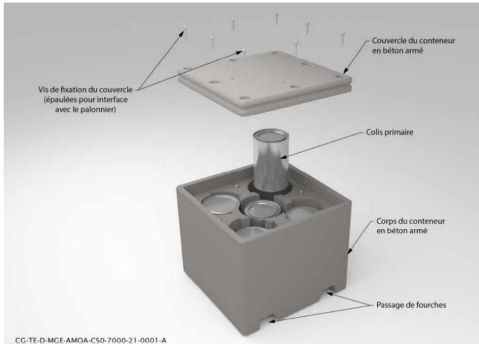
Figure 5-19 Illustration du conteneur de stockage béton renforcé vis-à-vis de l'incendie pour les colis de déchets bitumés stockés en l'état
