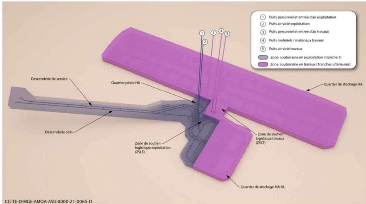
Figure 2-10 *Illustration de principe de la séparation des zones souterraines en exploitation et en travaux et des liaisons surface-fond associées (dimensions et proportions non représentatives)*
