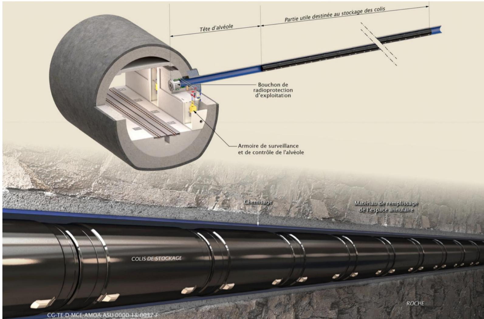
Figure 5-10 Illustration d'un alvéole HA en exploitation
