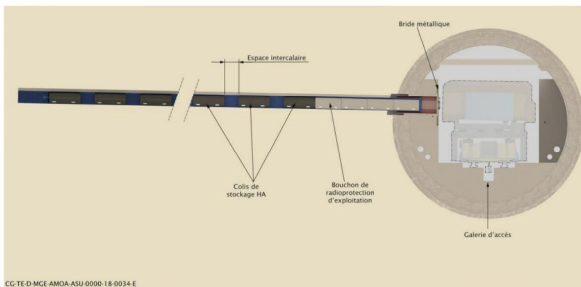
Figure 2-12 Coupe longitudinale schématique d'un alvéole HA
