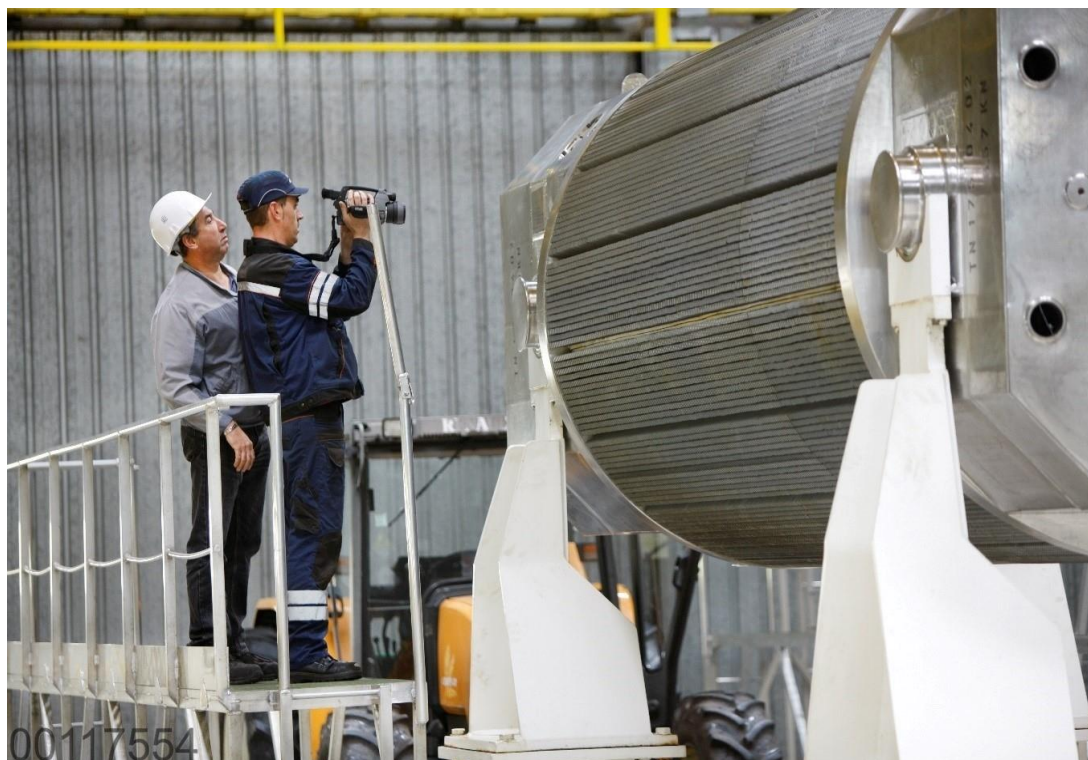
Figure Annexe 1-8 Exemple illustratif d'opérations de contrôle d'un emballage de transport menées sur une installation nucléaire
