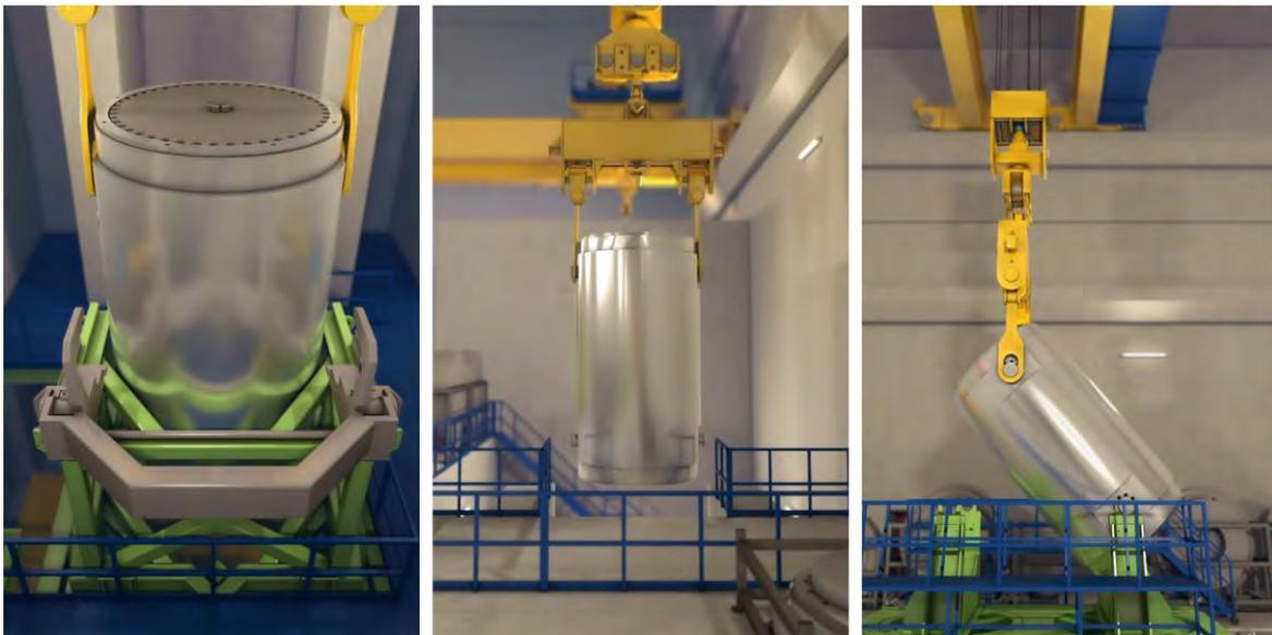
Figure 4-26 Illustration du transfert de l'emballage de transport pour sa réexpédition
