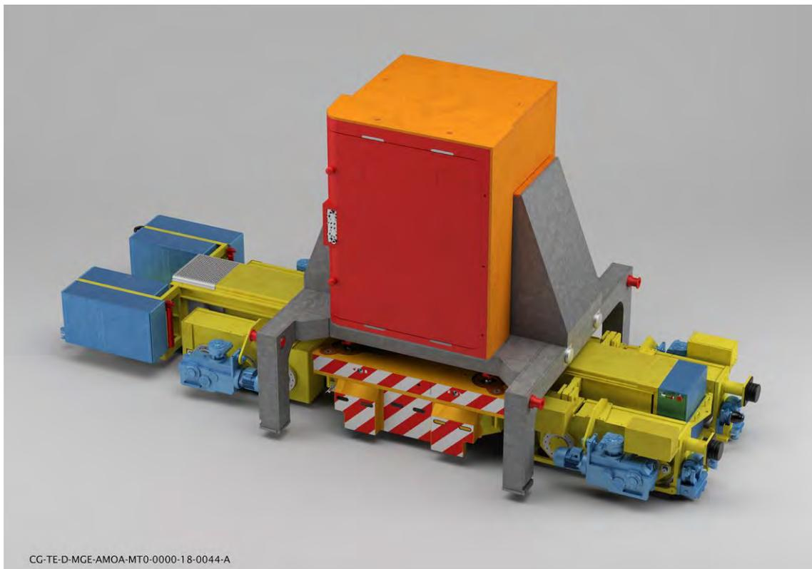
Figure 4-13 Illustration de la navette de surface chargée de la hotte MA-VL
