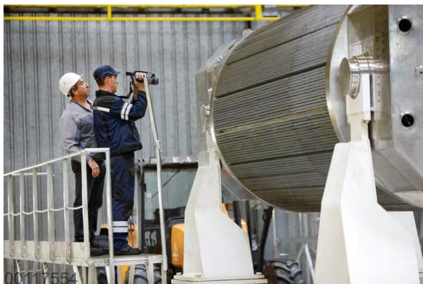
Figure 4-2 Photographie d'un exemple d'opérations de contrôle visuel d'un emballage de transport
