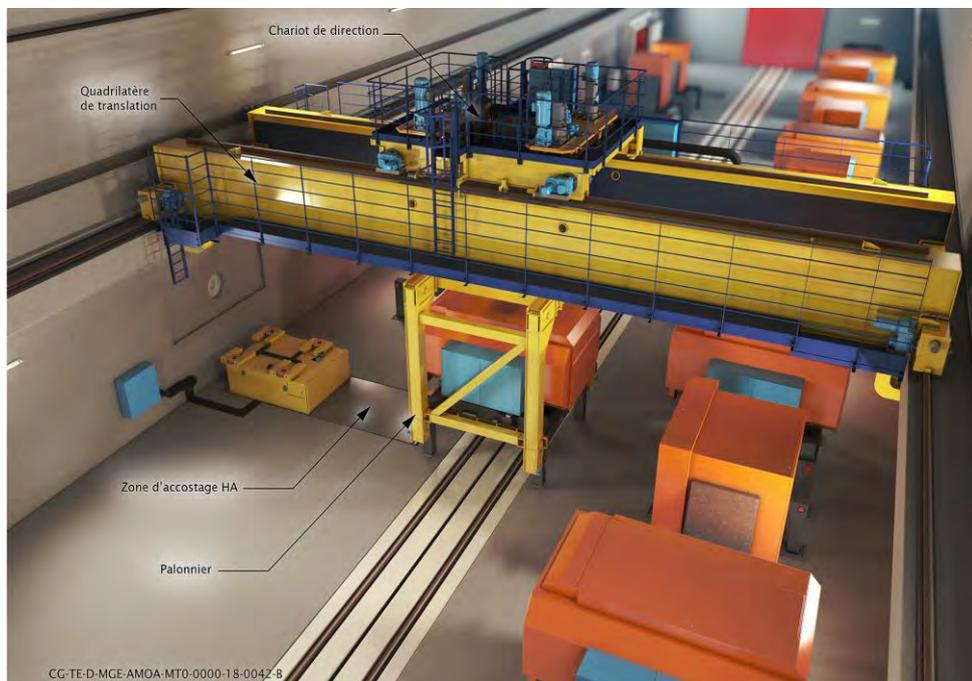
Figure 4-12 Illustration du parc à hottes et de sa machine à levage limitée (MLL)
