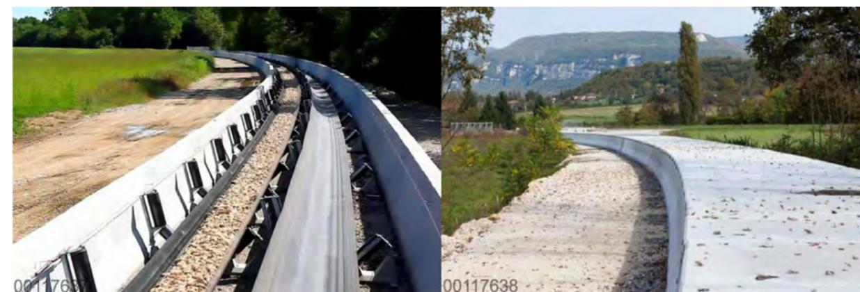
Figure 2-2 Exemple de convoyeur à bande en caisson béton
