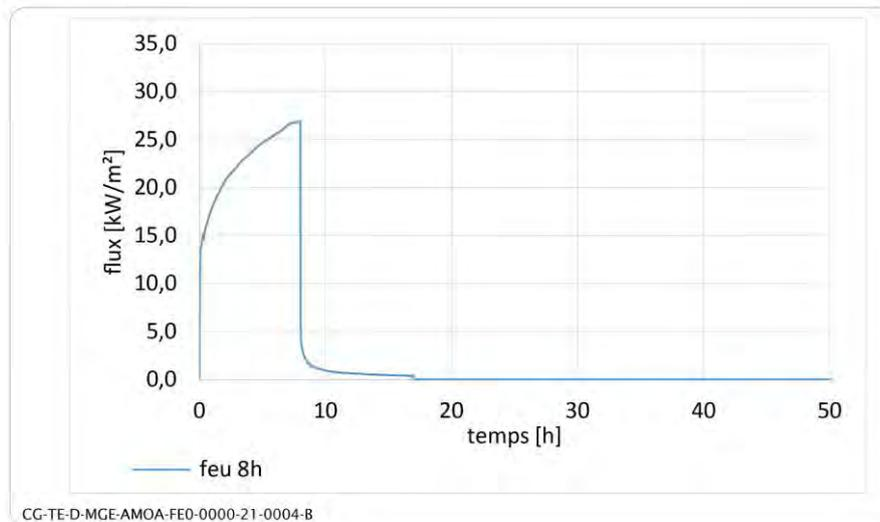
Figure 4-15 *Courbe incendie maximale appliquée pendant huit heures sur le colis de déchets bitumés stockés en l'état, pour le scénario d'emballage postulé sur les colis adjacents*
