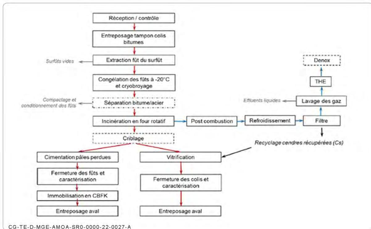
Figure Annexe 2-2 Diagramme fonctionnel du procédé de la filière 2 de traitement des déchets bitumés
