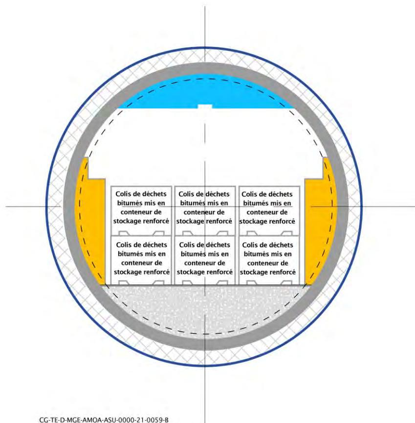
Figure 4-3 *Illustration de la section de l'alvéole dédié au stockage en l'état des colis de déchets bitumés et mis en conteneur renforcé vis-à-vis de l'incendie*
