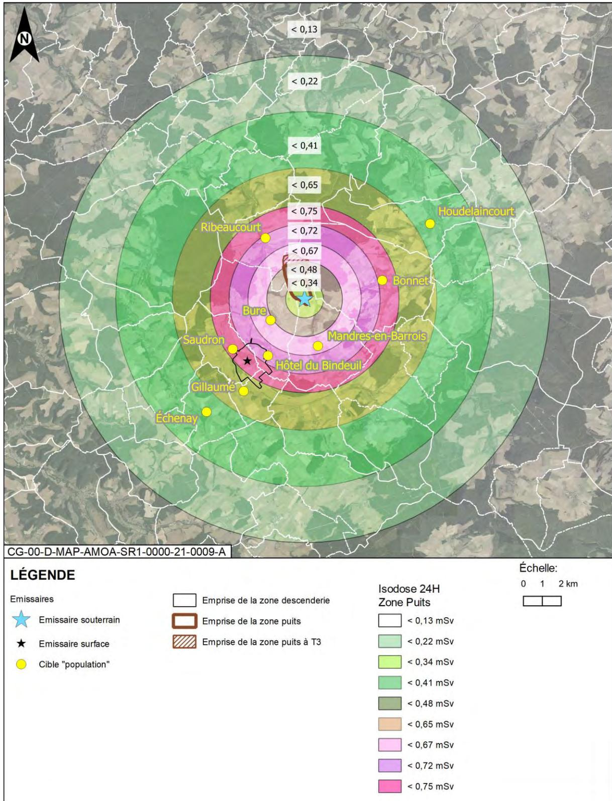
Figure Annexe 3-1 Doses maximales autour de la zone puits pour l'adulte pour une durée d'exposition de 24 heures, pour le scénario d'emballage postulé de déchets bitumés
