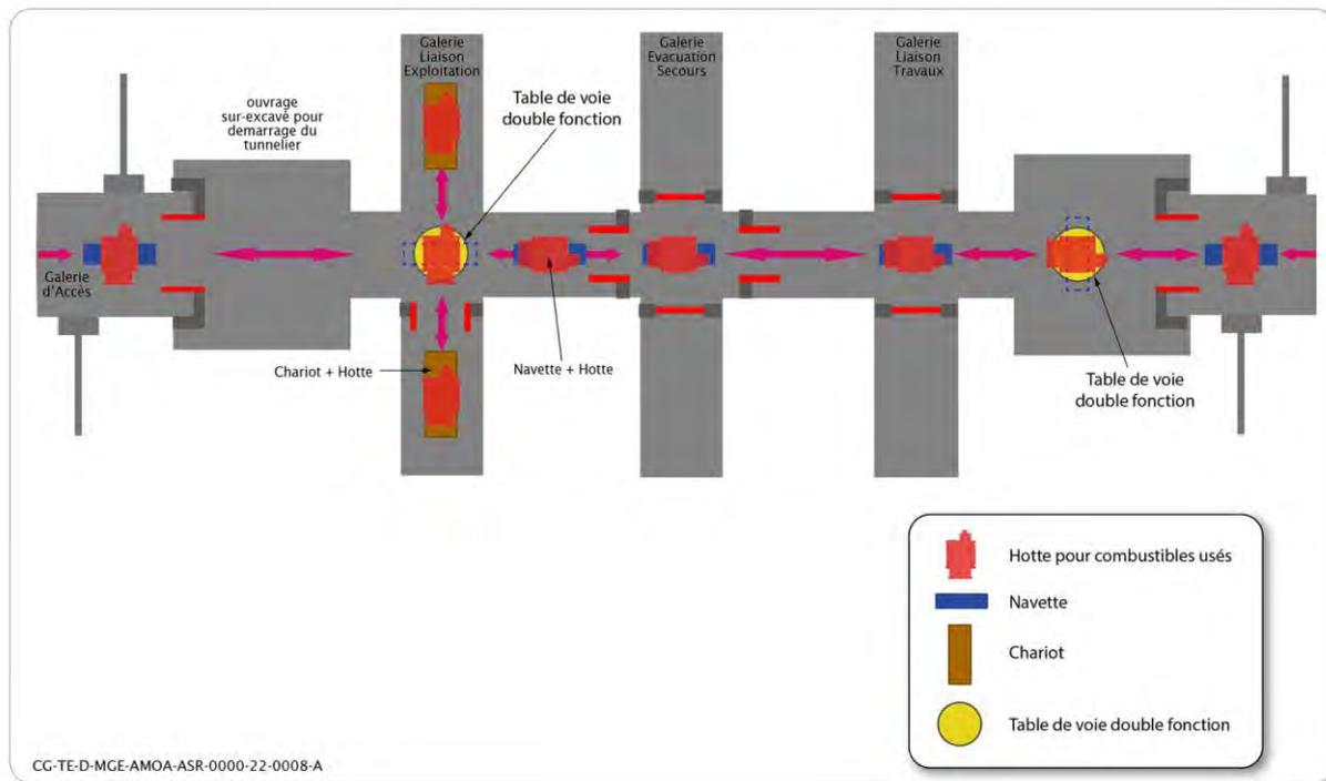
Figure 3-10 Circulation des hottes de transfert de combustibles usés dans les galeries de liaison
