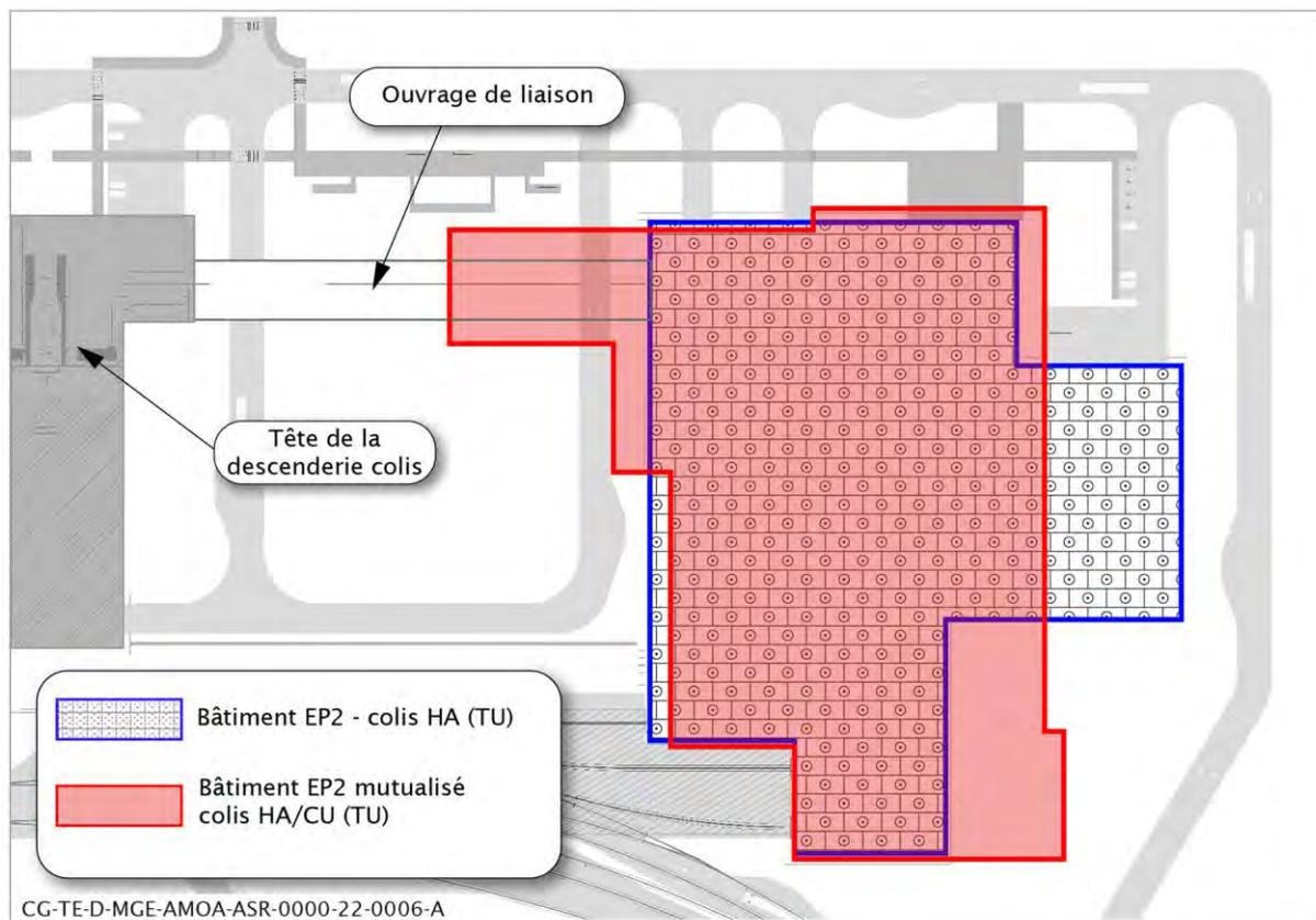
Figure 3-5 Solution possible d'emplacement d'un bâtiment permettant la gestion des HA et CU
