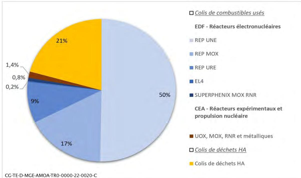
Figure 2-6 Répartition du volume de colis de stockage selon les différentes typologies de combustibles usés et de déchets HA- Scénario SNR enveloppe
