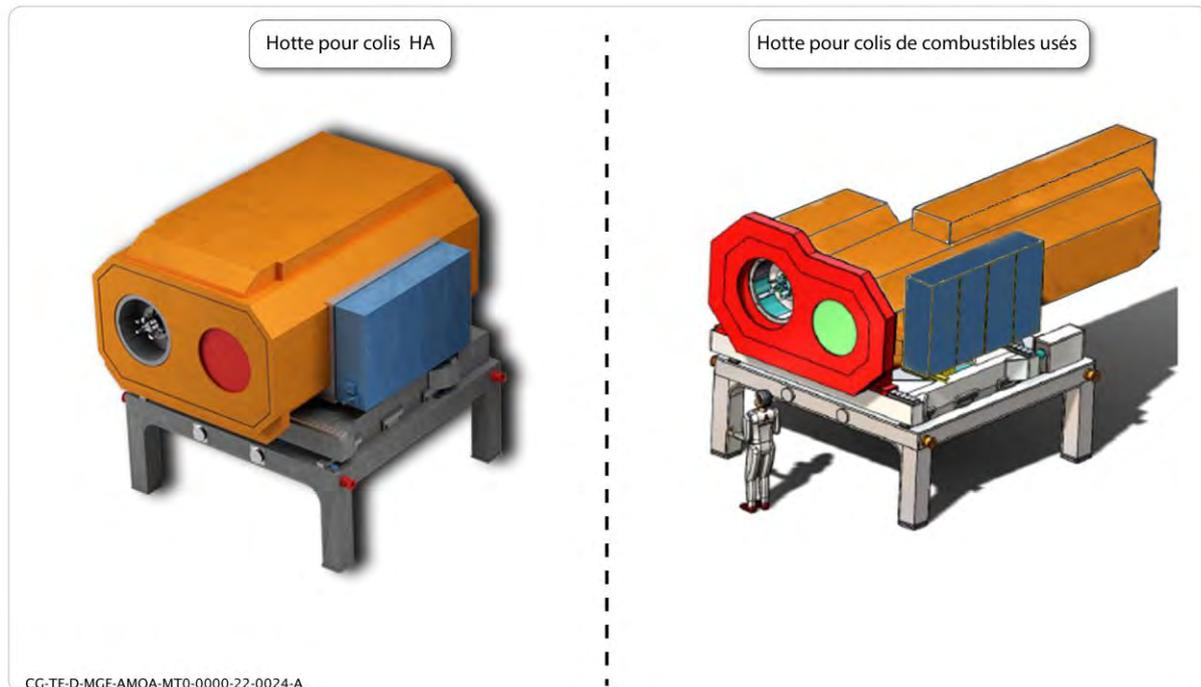
Figure 3-6 Gabarit des hottes de transfert pour les colis de déchets HA et pour les combustibles usés
