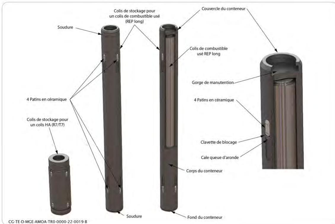
Figure 2-5 *Illustration d'un conteneur de stockage de colis de combustible usé et comparaison avec celui d'un colis de déchet HA*
