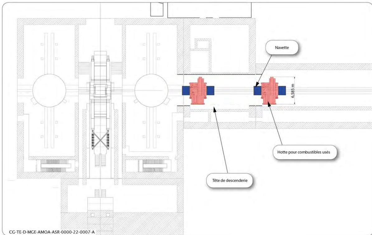
Figure 3-8 Transfert des colis CU vers la gare haute du funiculaire
