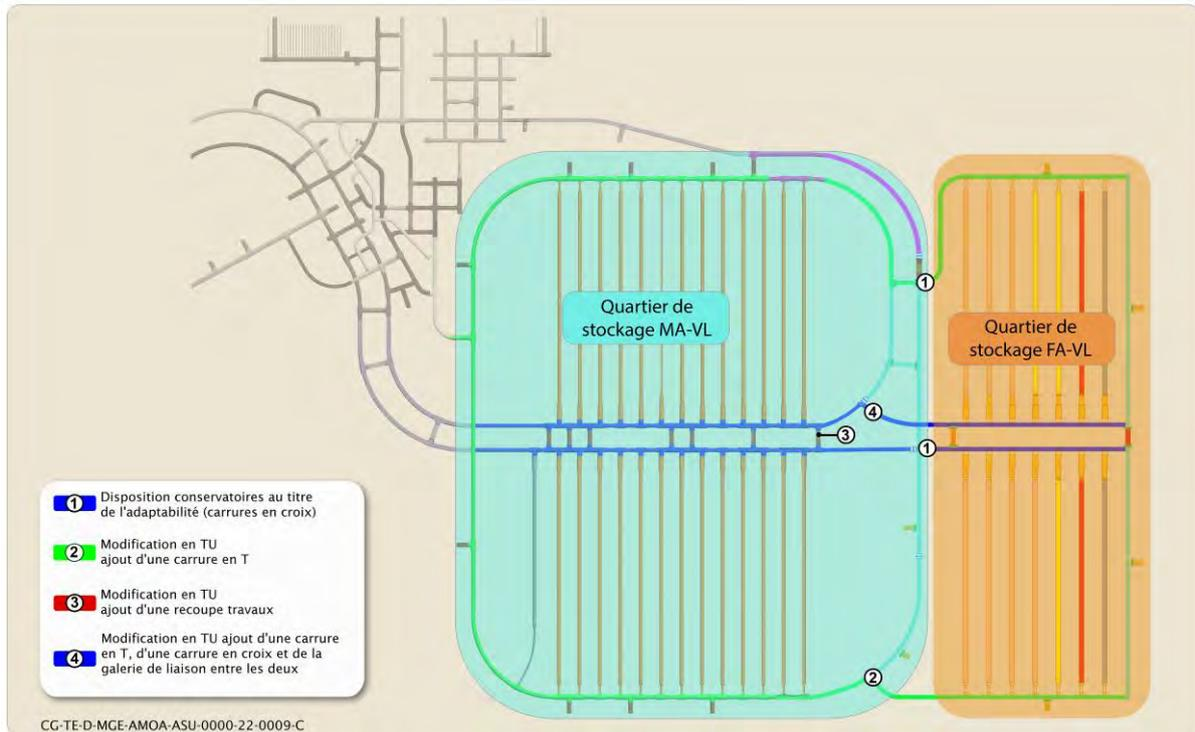
Figure 3-11 Les adaptations des ouvrages de la zone de stockage MA-VL lors des tranches ultérieures (TU)
