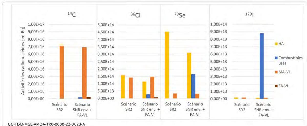
Figure 2-10 Comparaison des activités du carbone 14, du chlore 36, du sélénium 79 et de l'iode 129 pour les colis de déchets HA, MA-VL, FA-VL et combustibles usés entre le scénario SR2 et le scénario SNR enveloppe + FA-VL
