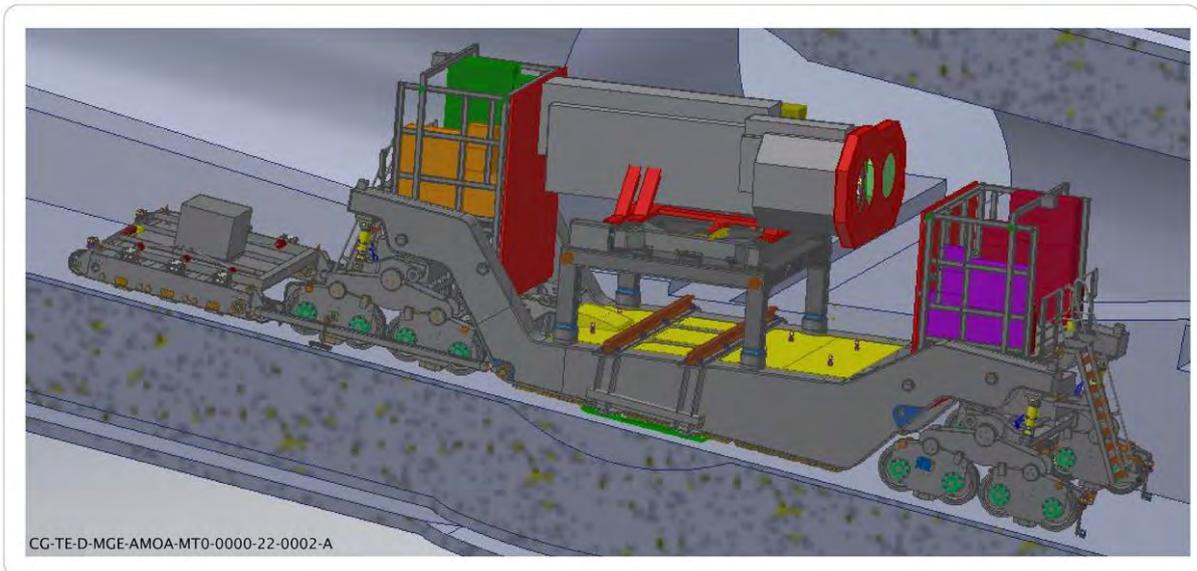
Figure 3-7 Hotte de transfert de combustibles usés sur le funiculaire
