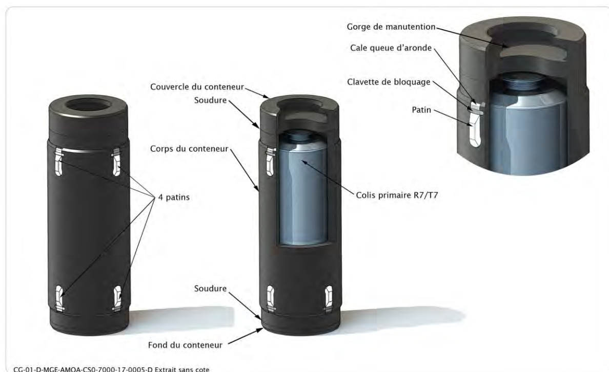
Figure 1-8 Illustration du conteneur de stockage HA pour colis primaire de déchets vitrifiés de type R7 T7
