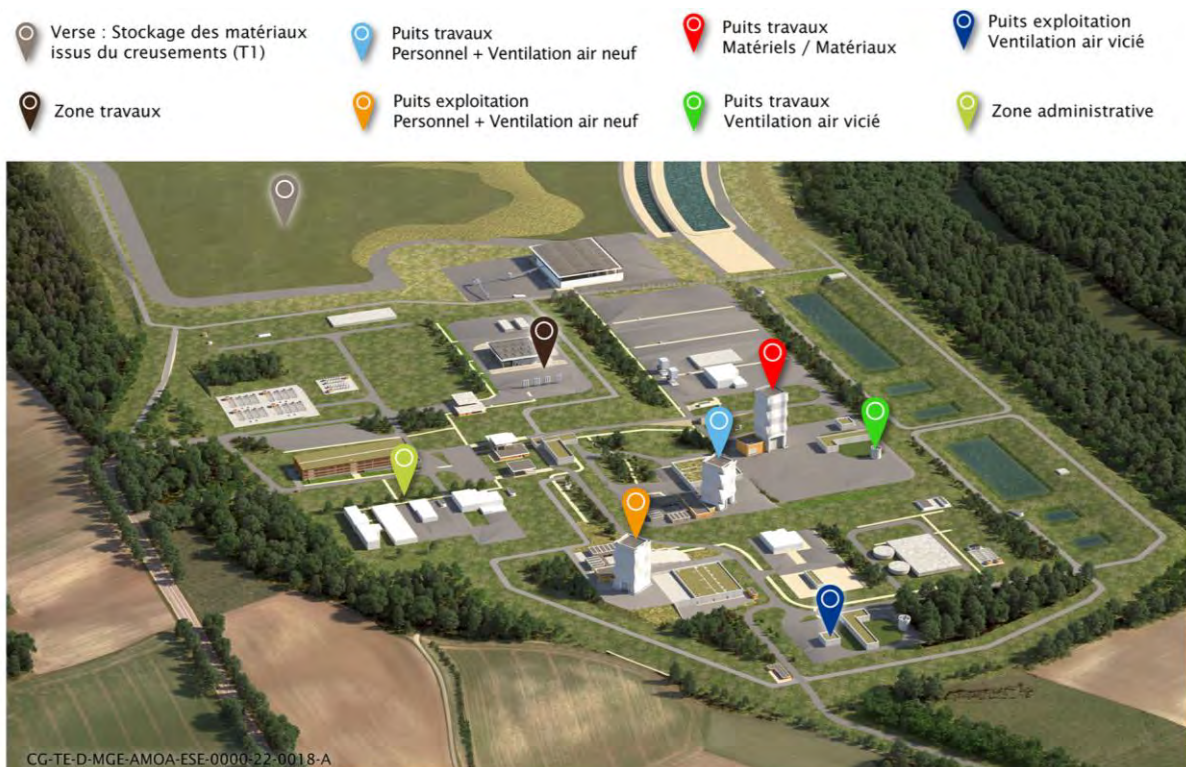
Figure 2-5 Vue de principe de la zone puits
