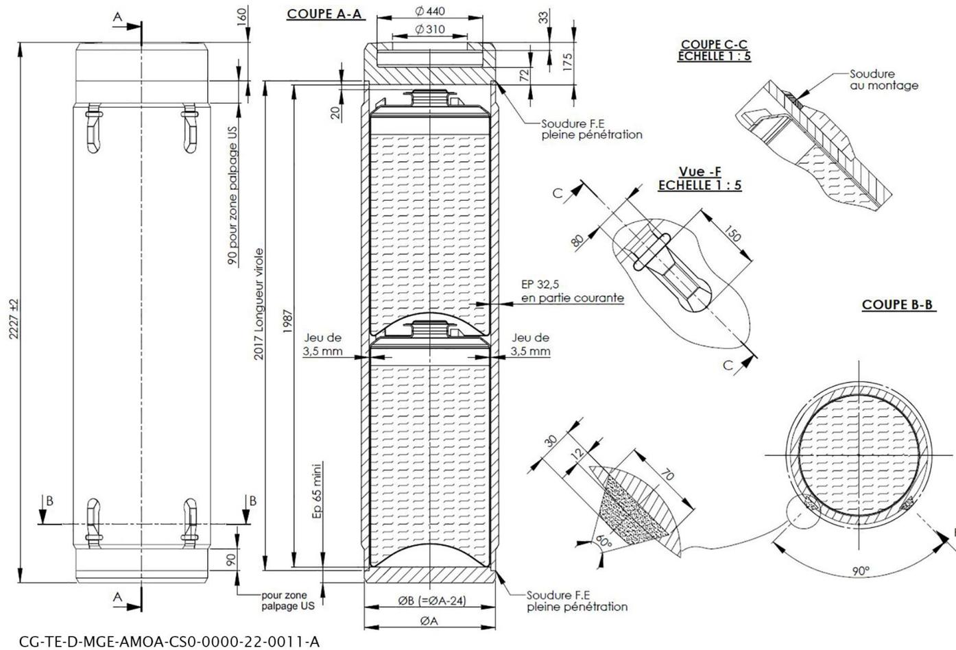
Figure 5-5 Géométrie du conteneur de stockage CS 15 à considérer dans les calculs de radioprotection
