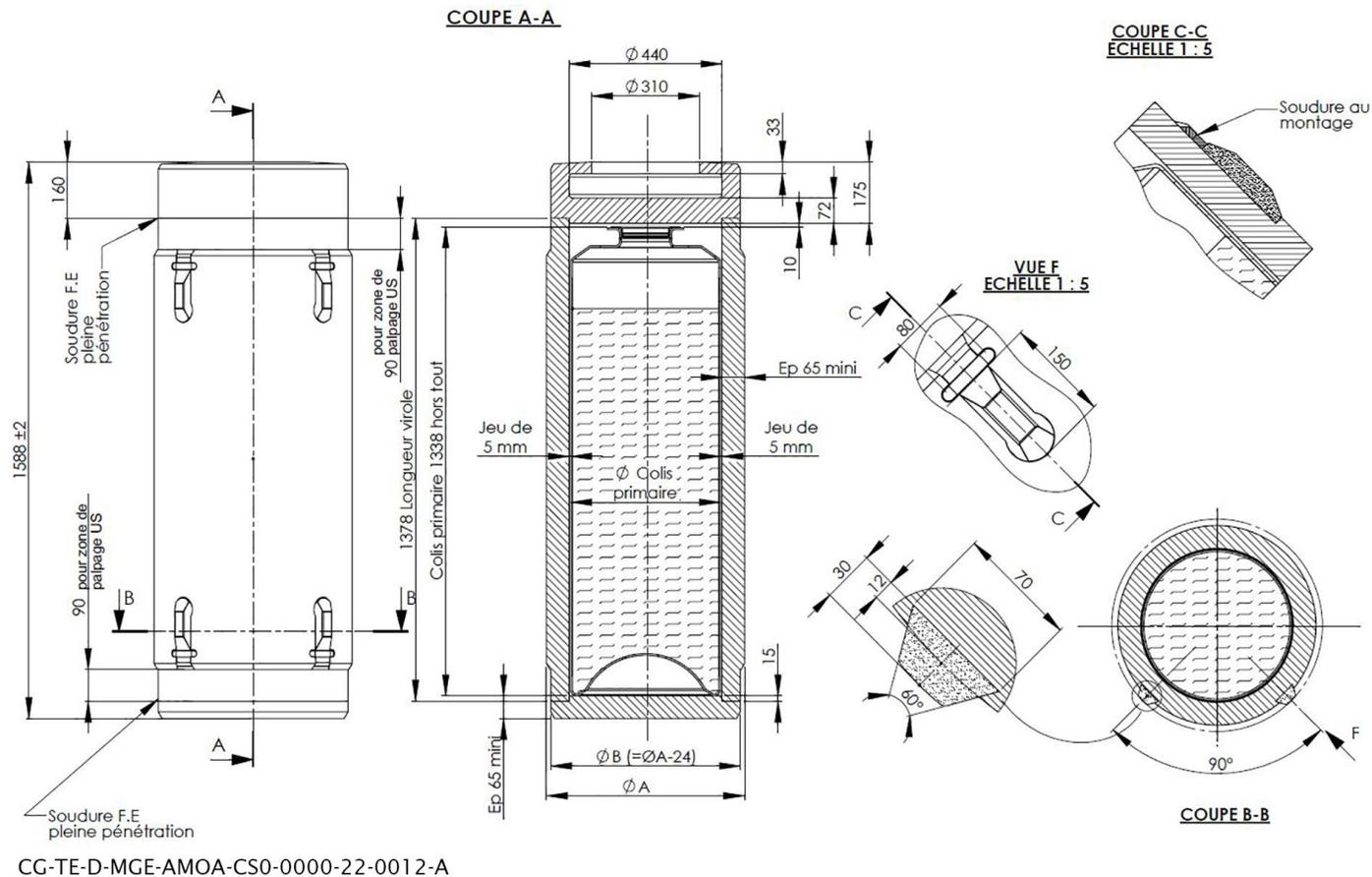
Figure 5-4 Géométrie du conteneur de stockage CS 13 à considérer dans les calculs de radioprotection
