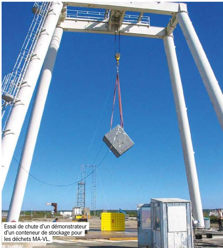
Essai de chute d'un démonstrateur d'un conteneur de stockage pour les déchets MA-VL.
