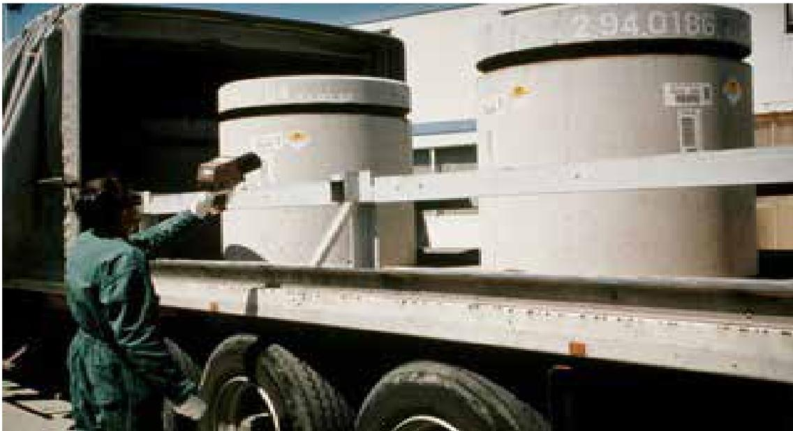
Contrôle radiologique d'un colis béton à son arrivée sur le CSM (© Andra)
