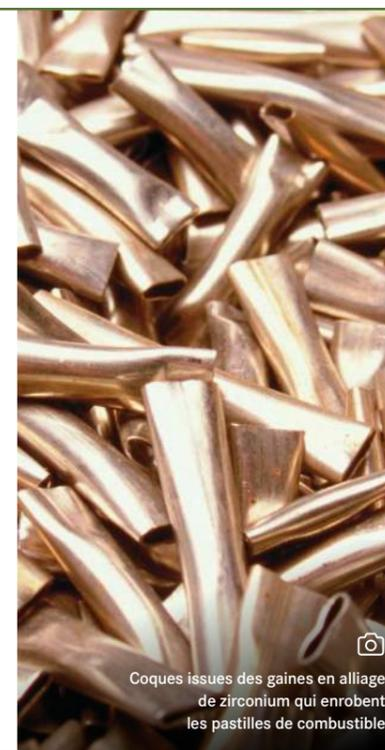
Coques issues des gaines en alliage de zirconium qui enrobent les pastilles de combustible
