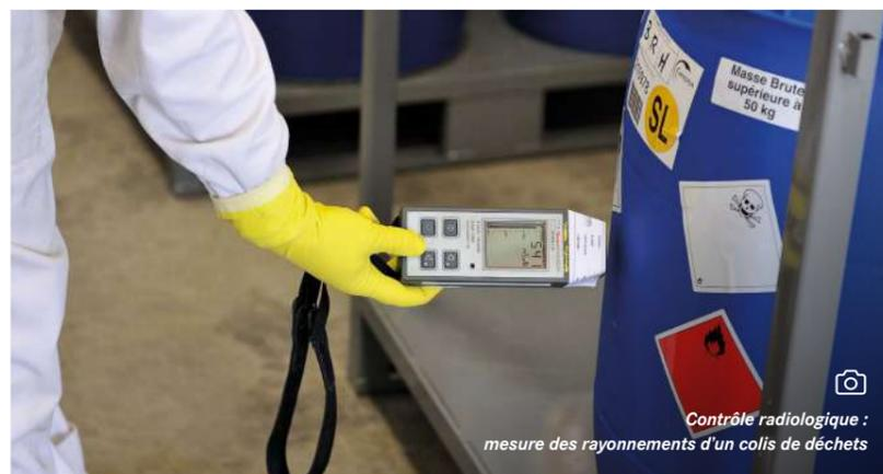
Contrôle radiologique : mesure des rayonnements d'un colis de déchets
