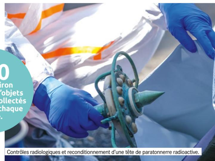
Contrôles radiologiques et reconditionnement d'une tête de paratonnerre radioactive.
