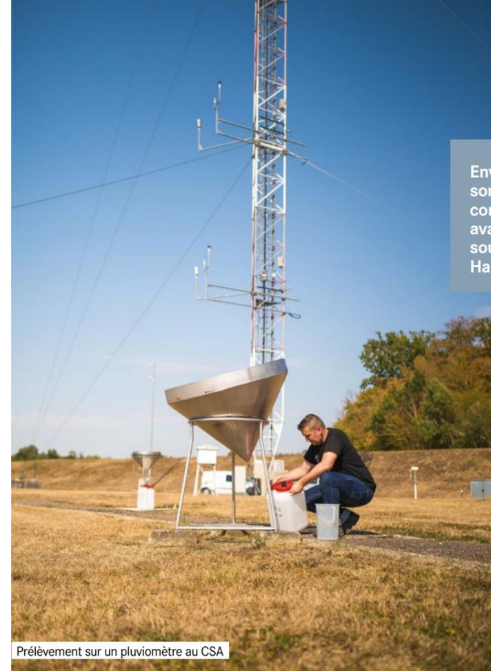
Prélèvement sur un pluviomètre au CSA
